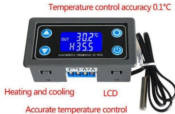
Ilustración 24.- Termostato digital indica el control de la temperatura y humedad. Fuente manualplus
